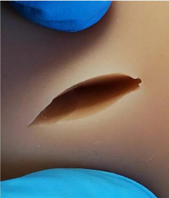
In den geöffneten Einschnitt wird nun mit dem Pinsel sehr wenig Diffusionsklebstoff gegeben und vorsichtig verteilt.
