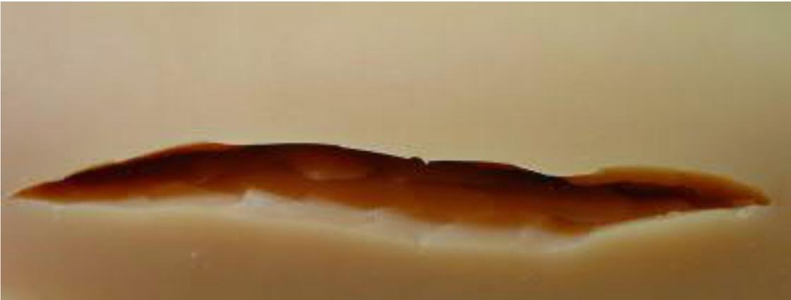
Der Einschnitt wird zuerst in der Tiefe und über die komplette Länge verschweißt.
