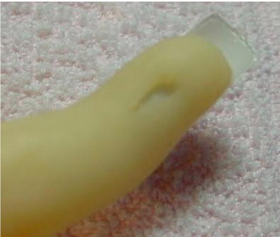
Der Riss wird mit den Fingern fast geschlossen. In den schmalen Spalt wird nun mit dem Zahnstocher sehr wenig Diffusionsklebstoff gegeben.
